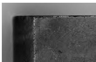
Выкрашивание режущей кромки
