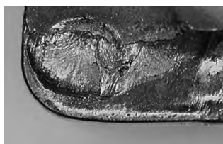
Износ по передней поверхности
