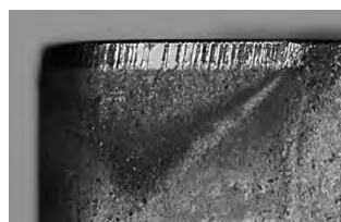
Износ по задней поверхности
